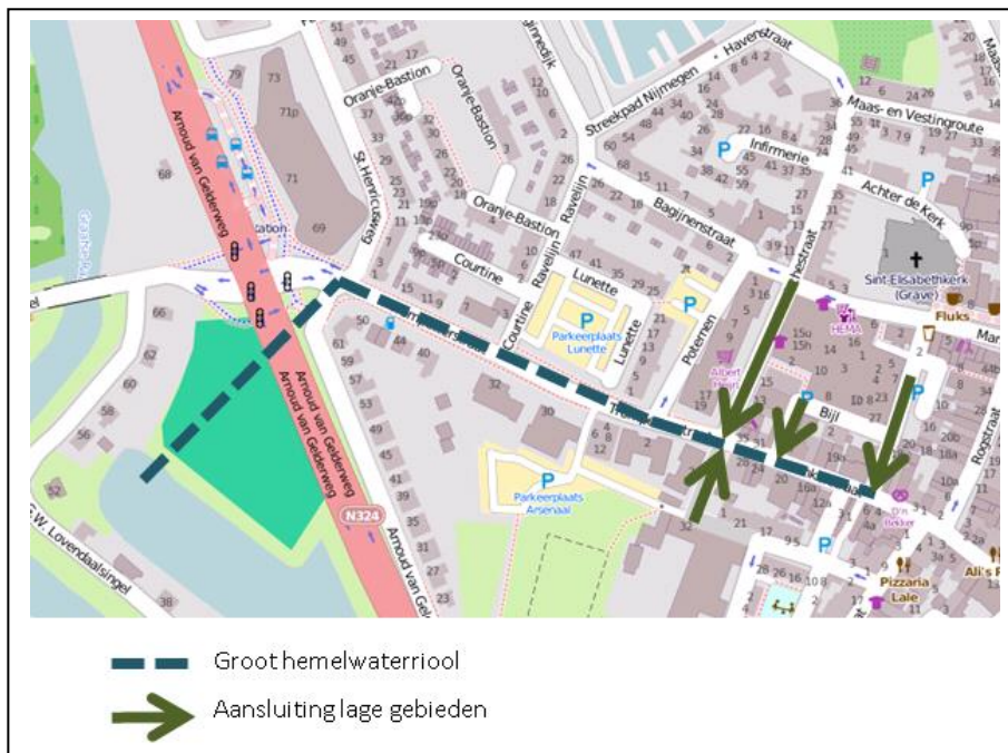
Figuur 9: Hemelwaterriool Trompetterstraat
